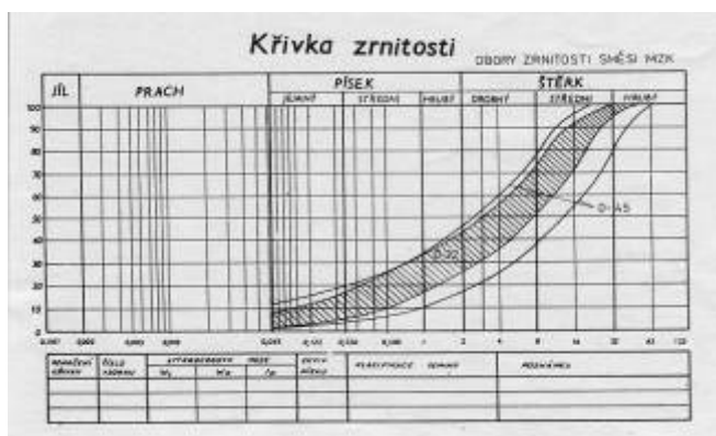
Obr. 3 Výsledná zrnitostní skladba směsi mechanicky zpevněného kameniva
